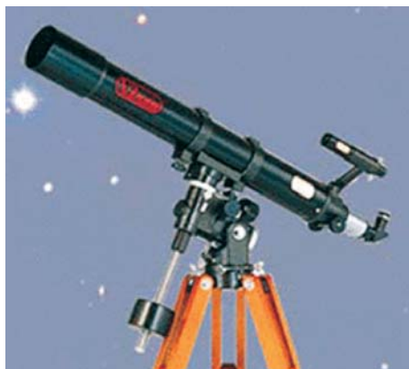
Fig. 52 - Telescopio e obiettivo (due lenti con vetri d'indice di rifrazione diverso).
