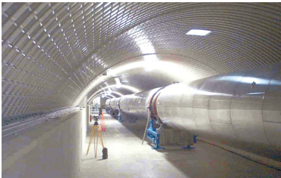
Fig. 10 - Il tubo a vuoto del braccio Nord di Virgo.
