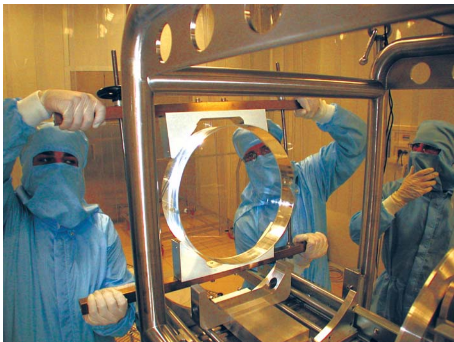
Fig. 11 - Gli specchi di Virgo sono costituiti da dischi di quarzo amorfo ultrapuro di 35 cm di diametro e 10 cm di spessore; essi appaiono trasparenti nelle fotografie poiché sono riflettenti solo per la luce infrarossa del laser, che ha una lunghezza d'onda di 1,06 micron. Gli specchi possono essere manipolati solo con enormi precauzioni, in ambienti praticamente esenti da polvere.
