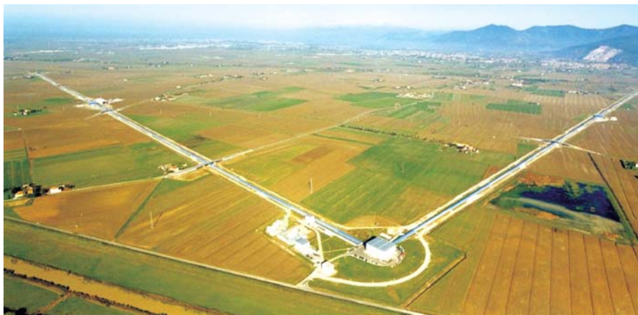
Fig. 9 - Il sito dell'European Gravitational Observatory (EGO) nella pianura di Cascina, presso Pisa. Sono ben visibili i bracci di 3 km dell'interferometro Virgo.
